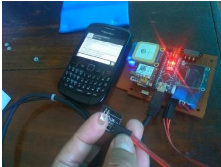
Gambar 8. Gambar Pengembangan Sensor Detak Jantung dan koneksi dengan Modul GSM
