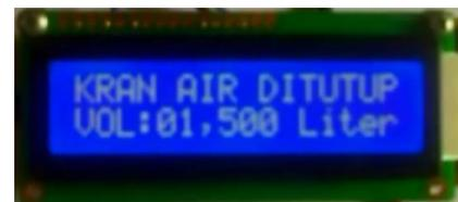
**Gambar 19. Penutupan kran solenoid**
