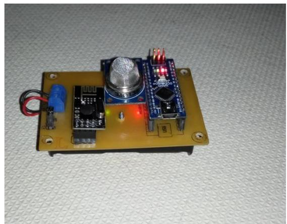
Gambar 20. Hardware modul node sensor versi tanpa antenna
