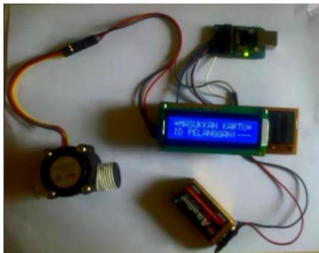
**Gambar 17. Perangkat keras pembaca volume air**
