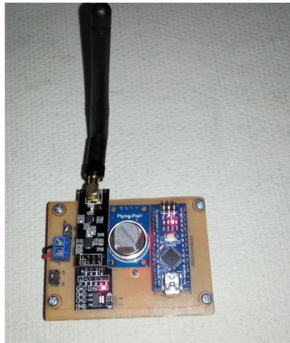
Gambar 19. Hardware modul node sensor versi dengan antenna
