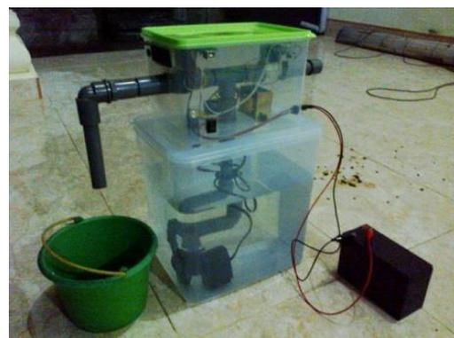
**Gambar 12. Prototipe sistem layanan air minum desa berbasis RFID**
