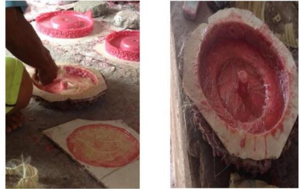
*Gambar 6. Penyusunan Serat Pada Cetakan Produk Wisata.*
