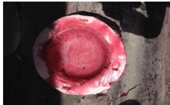
*Gambar 7. Proses Pelapisan Akhir Agar Serat Agave Sisal Terlapis Secara Menyeluruh oleh Campuran Resin dan Katalis.*
