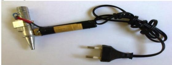
**Gambar 5. Hasil rancangan model 2 canting elektronik dengan pemanas PTC**
